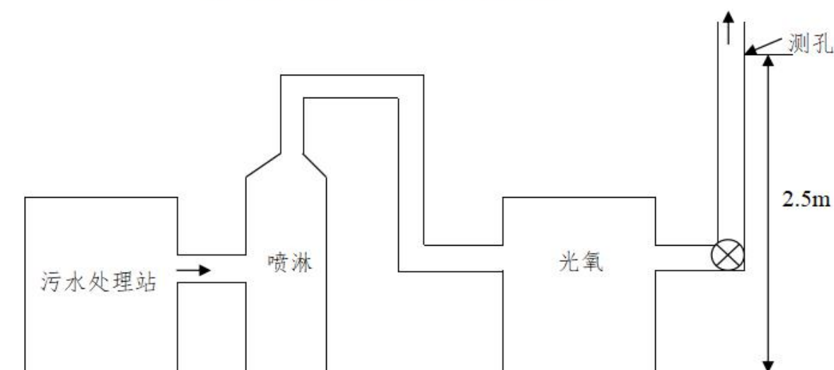
图 5-6 污水处理站废气排气筒布点图
