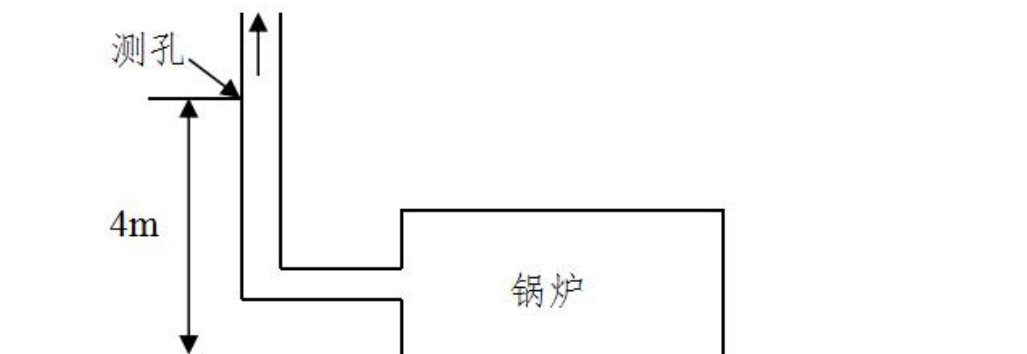
图 5-1 锅炉房排气筒检测布点图
