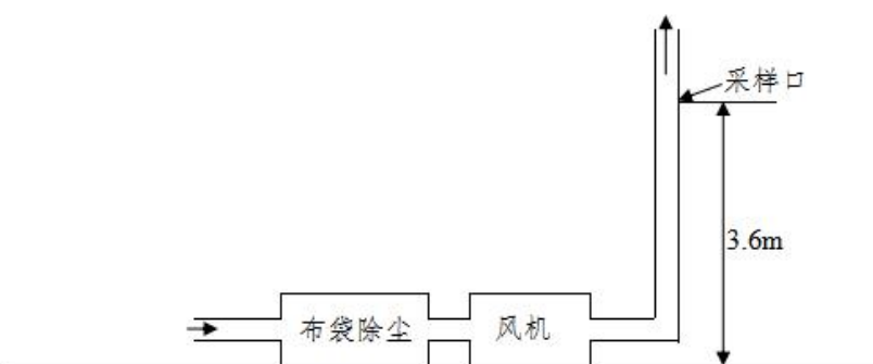
打磨车间 (3#) 废气检测布点图
