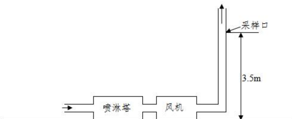
制壳车间废气检测布点图
