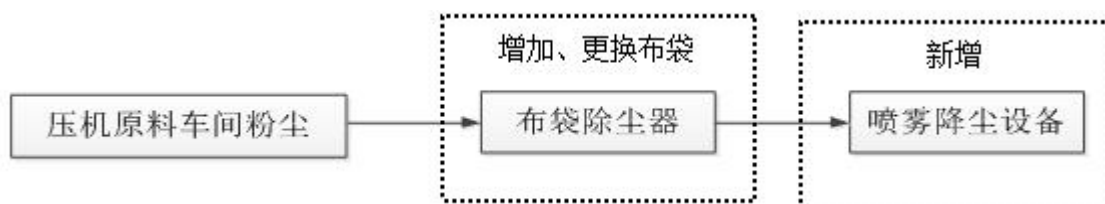
图 2-2 压机原料车间除尘工艺流程图
