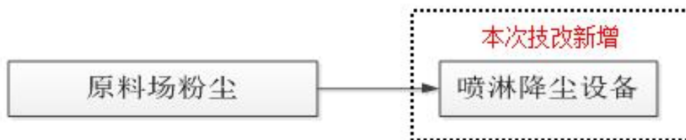
图 2-3 原料场除尘工艺流程图
